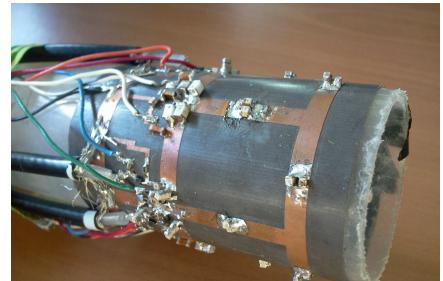
Fig. 1 : Photographie du capteur quatre canaux.
